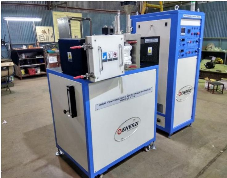
Опытная СВЧ установка для спекания топливных таблеток (МСЗ)
