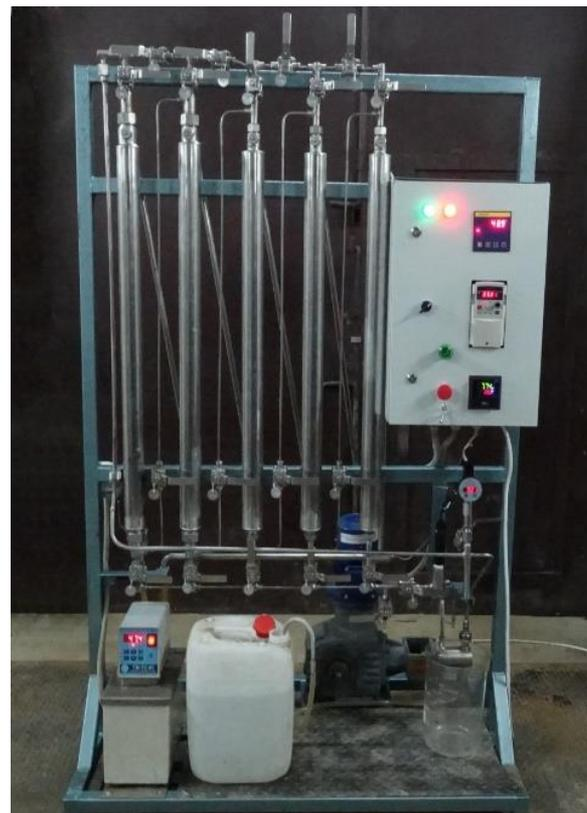
Макет хроматографической установки высокого давления (УХВД-100-2)
