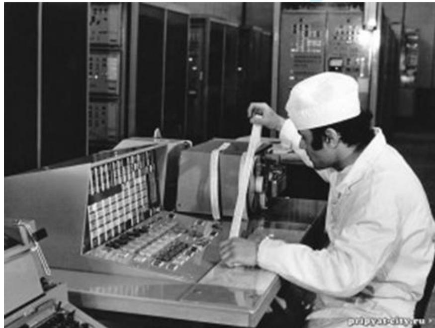
Несколько информационно-вычислительных машин ИВ-500 было введено в действие на ряде серийных блоков с реакторами ВВЭР-440, но из-за малых вычислительных возможностей эти машины выполняли только функции сбора информации, а также расчета отдельных технико-экономических показателей. На АЭС с реакторами ВВЭР с конца 70-х годов использовались ИВС «Комплекс-Уран», а затем «Комплекс-Титан» на базе вычислительных машин СМ-2М.
