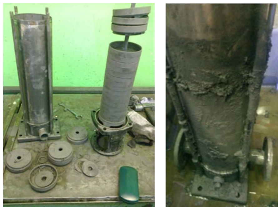
Рисунок 2 и 3 – Состояние насосов высокого давления СОЖ после демонтажа со станка ЧПУ занимающегося обработкой силицированного графита.
