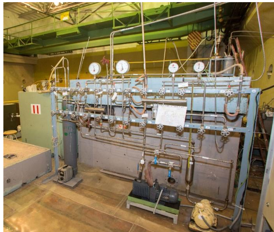
Модуль ЛУИЗА-РАО для нейтрализации недренлируемых остатков Na в баках, петлях, ХЛО
