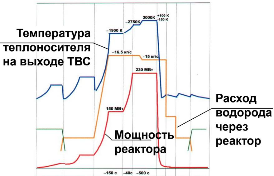
Рисунок 1 -Типовая диаграмма пусков
