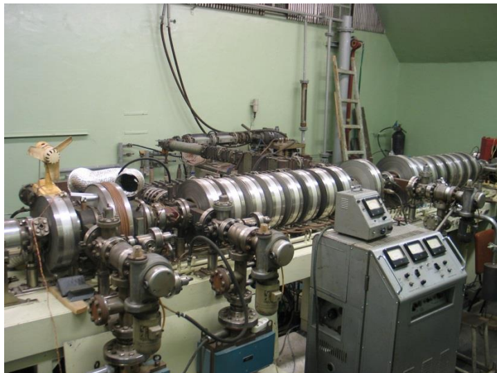
ЛУЭ У-28 (10 МэВ / 1 А – прототип «Факела» и ЛУ-50)
