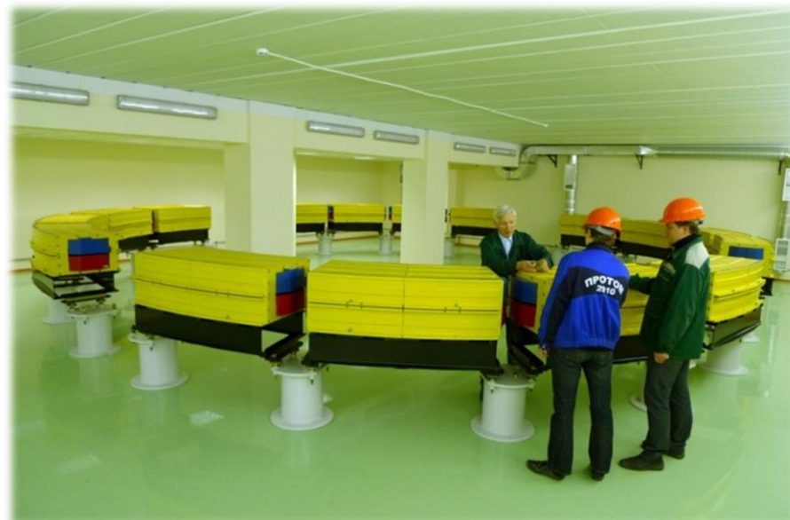
Сборка ускорителя ионов углерода на энергию 5,1 Гэв, г. Протвино, ЗАО «ПРОТОМ»
