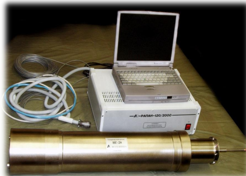
Генератор нейтронов с запаянной трубкой для внутриполостной брахитерапии
