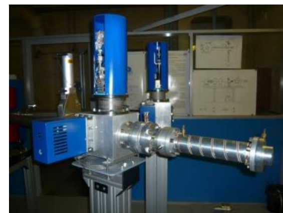
Мишенное устройство для производства радионуклида углерод-11
