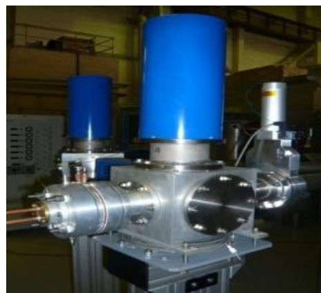
Мишенное устройство для производства радионуклида фтор-18
