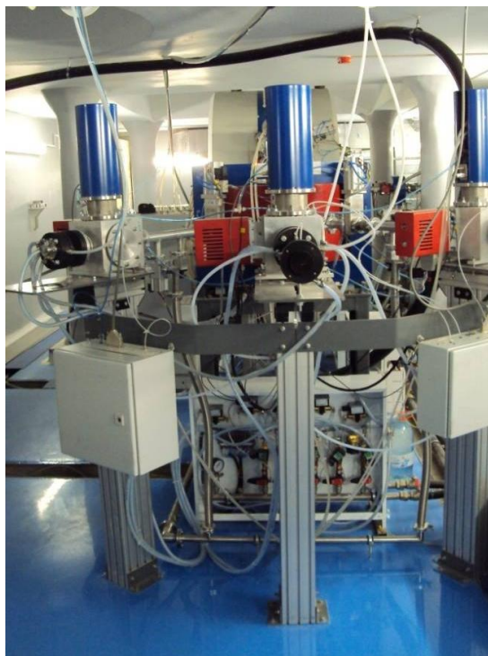
Мишени, установленные на циклотронном комплексе СС-18/9М в АО «НИИТФА»
