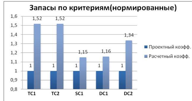
ТВЭЛЫ обоснованы с достаточными коэффициентами запаса для условий эксплуатации в 22-24 загрузке 3 блока Балаковской АЭС.
