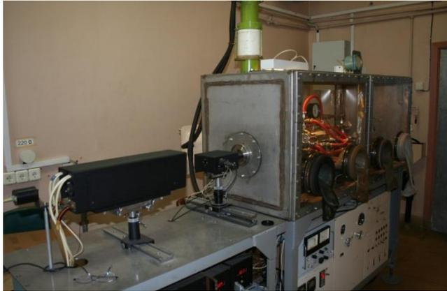
Установка для исследования теплофизических характеристик материалов «Квант – Б»
