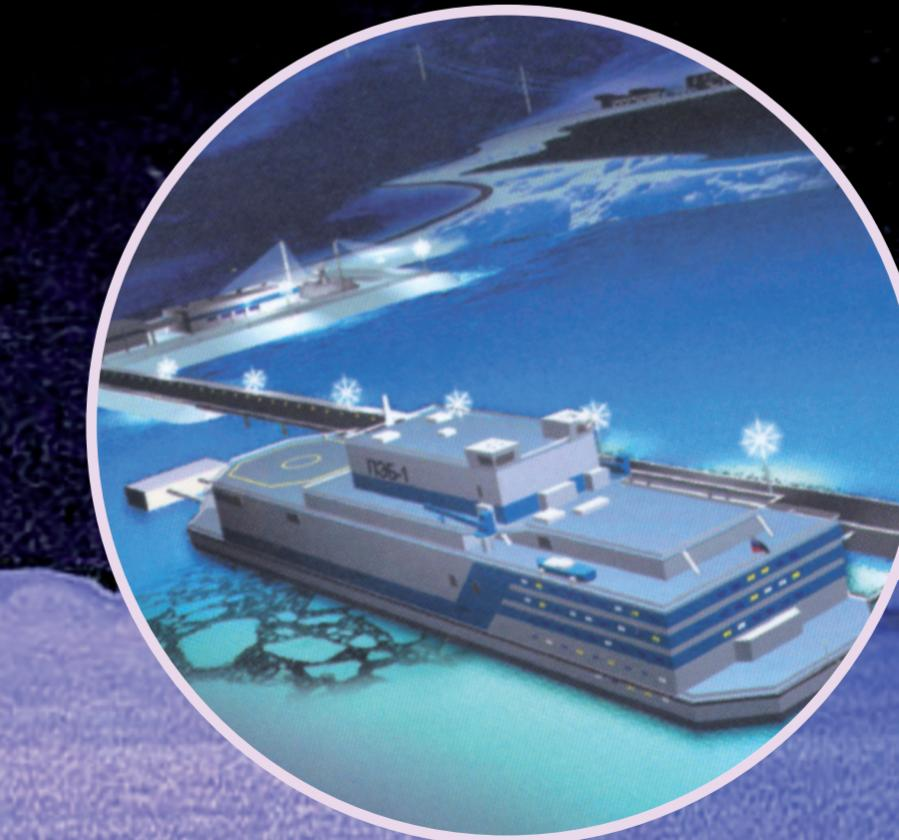
Плавучая атомная электростанция (ПАТЭС) создана на базе блока малой мощности – 100 МВт – подаваемых в виде тепла и электричества. Также ПАТЭС может опреснять воду. Предлагается к применению на Крайнем Севере России, на зарубежных островных и анклавных территориях, куда затруднена поставка энергии иным способом. Первая ПАТЭС «Академик Ломоносов» сейчас сооружается в России.
